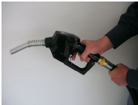
Verriegelungshebel einrasten. Zapfpistole ist jetzt geöffnet.
