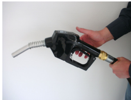
Verriegelungshebel einrasten. Zapfpistole ist jetzt geöffnet.
